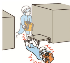
日めくり事故事例集No.17 両手でウエハカセットを持って 歩行中に転倒
