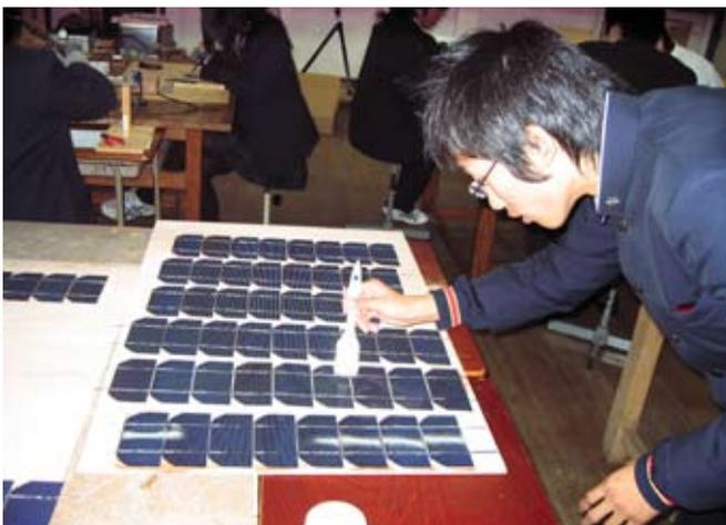
写真3 太陽電池セルの割れをチェック
