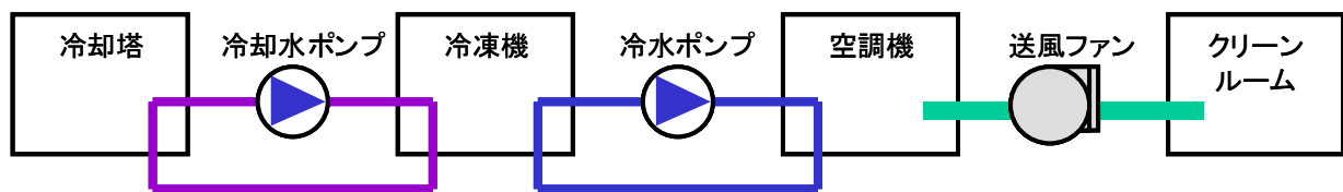
図 FI-9-1 冷水システム
